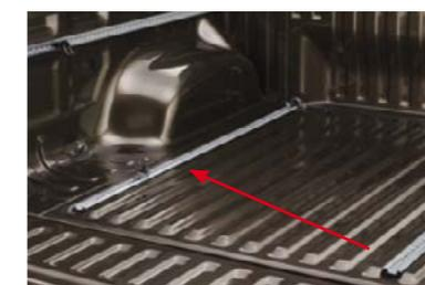
Système de rails pour surface de chargement
